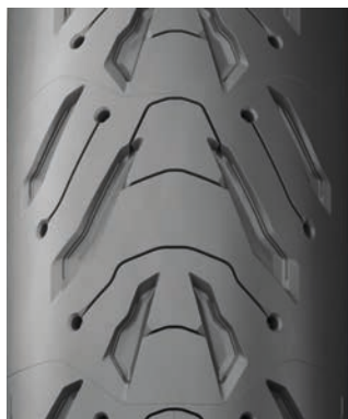
Das Profil des jüngsten Michelin-Motorradreifens ist durch neue Rillen und Lamellenwinkel charakterisiert, womit der Hersteller eine entsprechend größere Länge der Kanten verbindet, die den Wasserfilm durchschneiden und somit ein Mehr an Grip bei Nässe bieten (Bild: Michelin)
