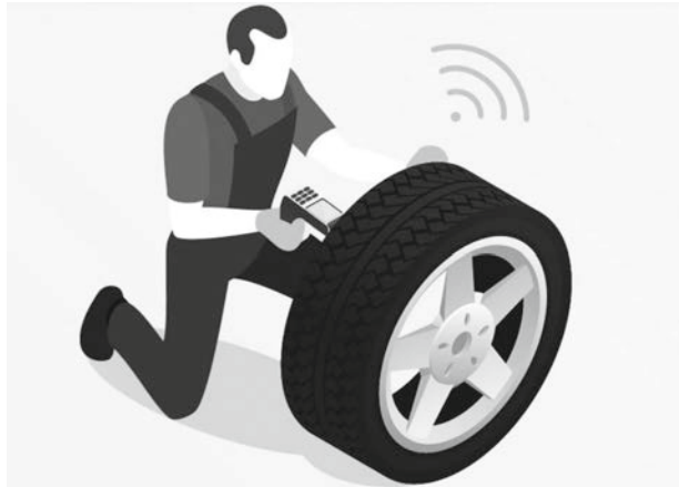
In Reifen integrierte sogenannte RFID-Chips bzw. -Tags sollen dank per Funk kontaktloser Auslesemöglichkeit der darin gespeicherten Daten eine kostengünstige und einfache Rückverfolgbarkeit über ihre gesamte Lebensdauer ermöglichen (Bild: Michelin)
