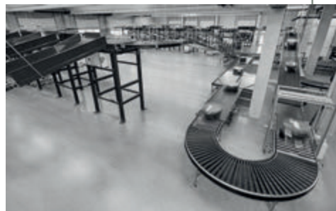
Eine Steigfördererstrecke bringt die Versandeinheiten von der Arbeitshöhe (800 mm) auf die Förderhöhe von 3.300 mm (Bild: AMI)
