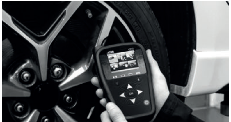
Das bei Hamaton erhältliche ATEQ-Gerät „VT37“ soll alle gängigen Erstausrüstungs- und Ersatzmarktsensoren aktiver RDKS auslesen, aktivieren und konfigurieren können (Bild: Hamaton)
