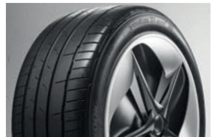
Das Hankook-Profil „Ventus S1 Evo 3 EV“ ist Herstelleraussagen zufolge speziell für die Bedürfnisse von Elektrofahrzeugen entwickelt worden (Bild: Hankook)
