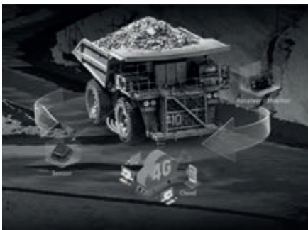
TIKS soll in Echtzeit die Betriebsdaten von Reifen an den Fahrer genauso wie über das Internet an das Fuhrparkmanagement übermitteln können (Bild: Techking)
