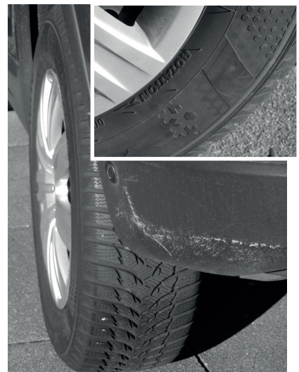
Nicht nur dem Reifenfachmann sollte eigentlich sofort auffallen, dass hier die Laufrichtung des Reifens hinten links (wurde vertauscht mit dem rechten Rad) nicht stimmt, zumal eine entsprechende Seitenwandmarkierung Zweifel erst gar nicht aufkommen lässt
