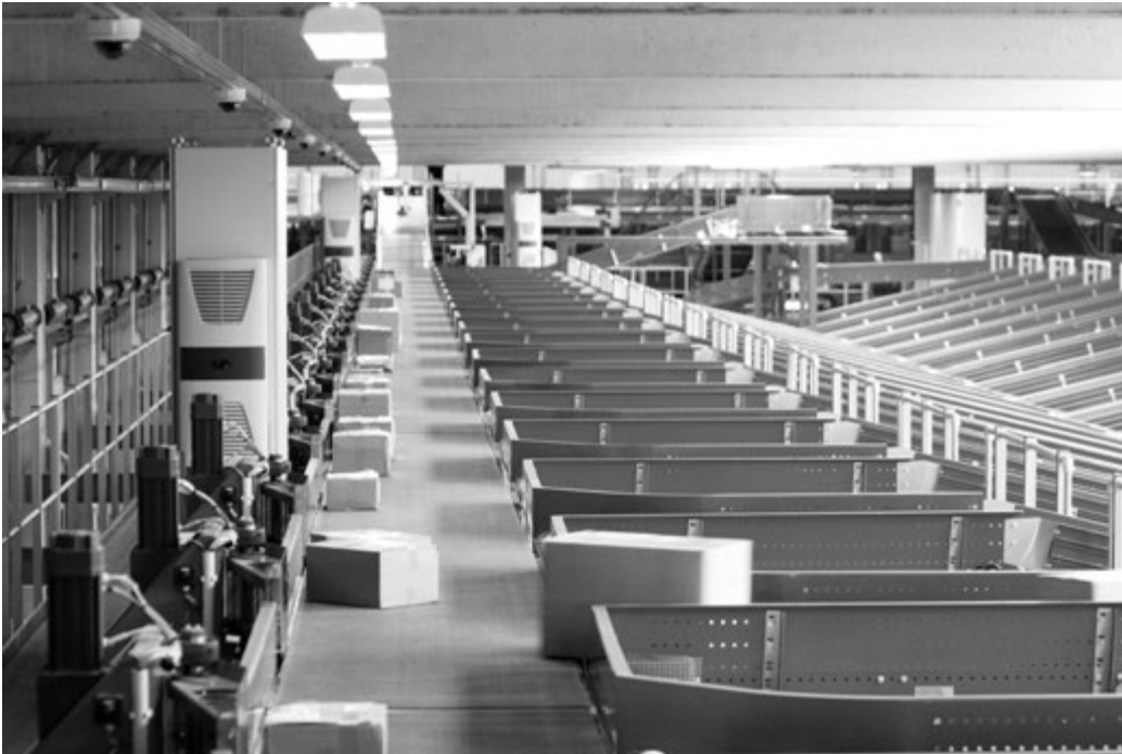
Um Pakete heute kosteneffizient zu sortieren, bedarf es eines hochkomplexen und hochintegrierten Systems, das vielfach automatisiert abläuft; es gibt dabei Pakete, die als non-conveyable gelten, also als nicht förderbandfähig, und die somit das System verlangsamen und es teurer machen: dazu gehören auch Reifenpakete
