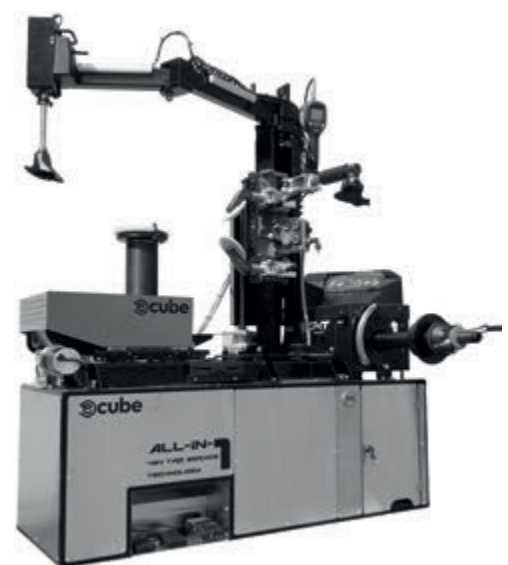
Als Einzelgerät soll „E-Cube“ deutlich mehr Arbeitsraum in einem Fahrzeug bieten und zugleich einen Generator überflüssig machen, sodass der damit verbundene Lärm oder von ihm ausgehende Abgase der Vergangenheit angehören
